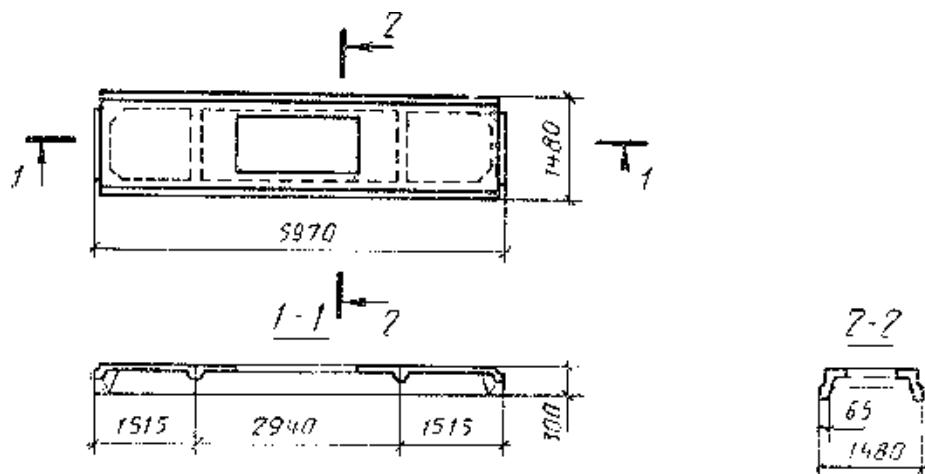
С двумя проемами размерами 1200x1700 мм
