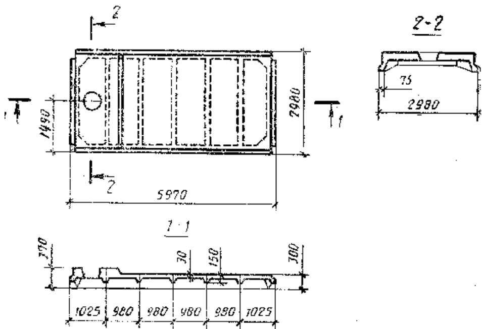
С проемом диаметром 1000 или 1450 мм
