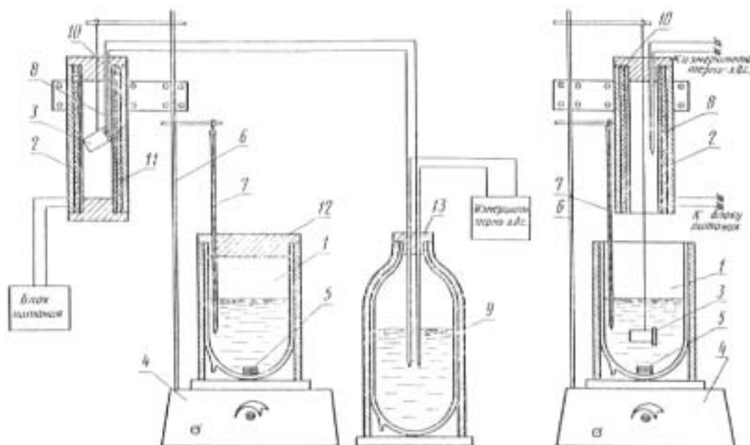
1 — калориметр; 2 — электронагреватель; 3 — капсула с образцом; 4 — магнитная мешалка; 5 — стержень магнитной мешалки; 6 — штатив магнитной мешалки; 7 — термометр
