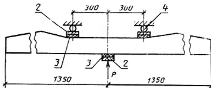
1 - стальная пластина с уклоном нижнего основания 1:20 размером 250x100 мм, средней толщиной 25 мм; 2 - стальная пластина размером 250x100x25 мм; 3 - резиновая прокладка размером 250x100x10 мм; 4 - стальной валик диаметром 40 и длиной 250 мм
