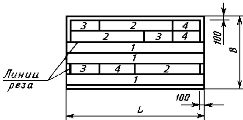
Места вырезки образцов: 1 - для проверки прочности и жесткости панелей при поперечном изгибе; 2 - для проверки плотности (объемной массы), прочности при растяжении, сжатии и сдвиге, прочности сцепления с листами при равномерном отрыве и сдвиге, модуля упругости при растяжении и модуля сдвига пенопласта; 3 - для определения коэффициента теплопроводности пенопласта; 4 - для определения влагопоглощения и водопоглощения пенопласта; L - длина панели; B - ширина панели.
