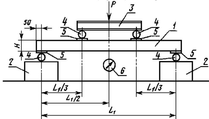
1 - панель (образец); 2 - база; 3 - траверса; 4 - цилиндрические опоры;
