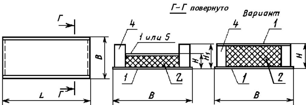
1 - асбестоцементный лист; 2 - пенопласт; 3 - обрамление; 4 - ребро; 5 - неметаллический лист;
