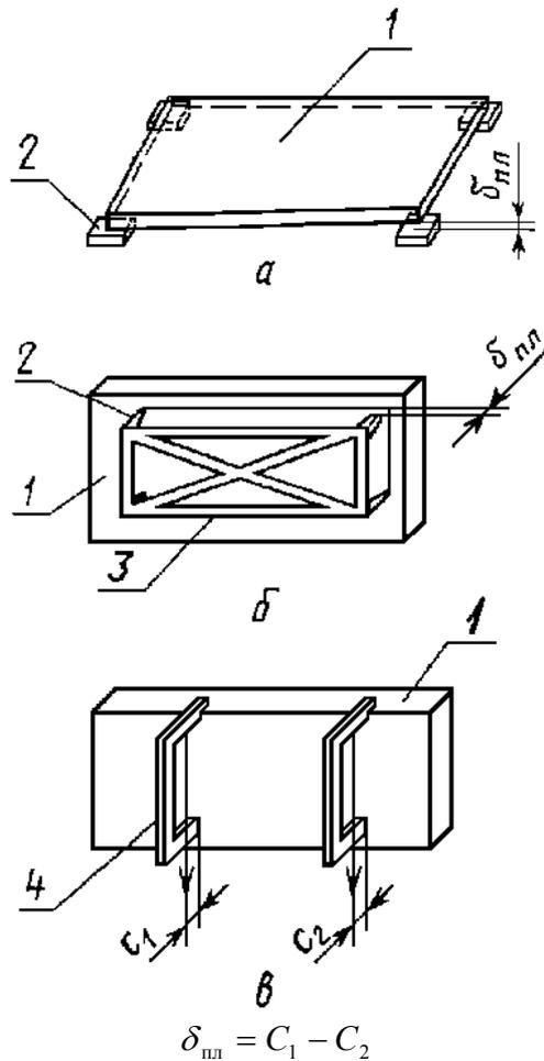
1 - панель; 2 - опоры; 3 - жесткий металлический шаблон; 4 - отвес-рейка
