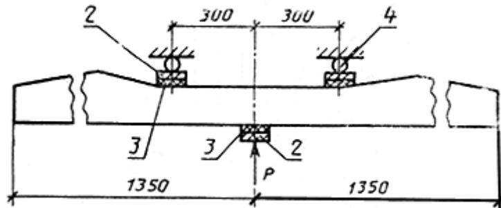
1 - стальная пластина с уклоном нижнего основания 1:20 размером 250x100 мм, средней толщиной 25 мм; 2 - стальная пластина размером 250x100x25 мм; 3 - резиновая прокладка размером 250x100x10 мм; 4 - стальной валик диаметром 40 и длиной 250 мм
